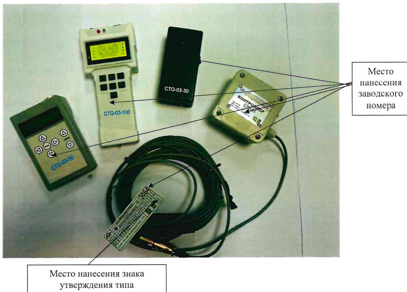
Рисунок 1 – Общий вид комплекса для измерений температуры грунтов СТО и места нанесения заводского номера, знака утверждения типа
